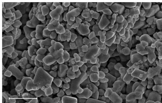
NANOMAG-MnZn est une poudre de ferrite Manganèse-Zinc (Mn,Zn)Fe<sub>2</sub>O<sub>4</sub>.
