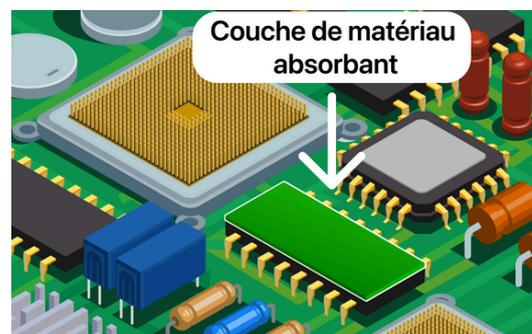
Leurs pertes magnétiques par absorption ( $\mu''$ ) et leur capacité à stocker le champ magnétique ( $\mu'$ ) étant élevées, ces plaques réduisent le bruit provoqué par le composant rayonnant.
